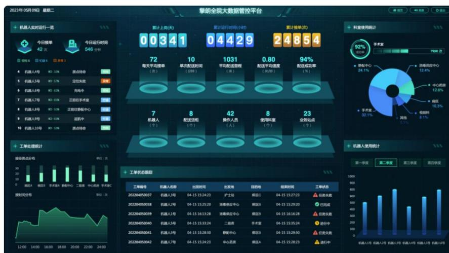
擎朗智能调度与运营管理平台融合了数字孪生和智能调度等前沿技术，实现了对物流机器人的全面掌控，提升了物流效率。通过物联网技术实现机器人与医院电梯、自动门等设备信息融合，借助增强现实技术3D可视化真实运行场景，提供更加沉浸式的交互体验，预警感知，取物提醒，物联感知，全面掌握机器人运行状态。实时监控机器人状态、位置和任务执行情况，异常情况即时提醒，配送全流程可追溯，保障配送安全。
