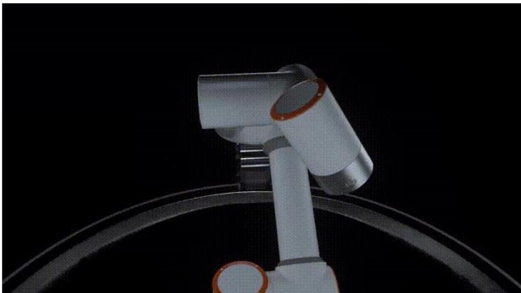
从公开的参数来看，FR5-SPARK 版本机器人本体拥有不错的性能，有效负载5KG，工作半径922mm，重复定位精度达 $\pm 0.02\text{mm}$ ，这种型号以及精度的机器人，无论是用于科研、工业或是服务多场景下的开发探索，都有较高的兼容度，能做到游刃有余。
