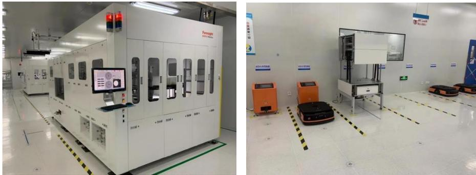
近日，福赛特推出了国内首套 MOCVD 晶圆倒片机及晶圆传输自动物流系统。此系统旨在实现 LED 半导体工厂核心工艺设备 MOCVD 的晶圆倒片及晶圆传输功能，由设备和子系统组成：MOCVD 晶圆倒片机，配置了防尘货架的 AGV，存储石磨盘的电子货架，和与 MOCVD 对接实现上下片功能的周转单元。
