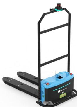
3月11日，仙知机器人发布了2020款基于SRC的激光SLAM地面式自动叉车。此款叉车负载能力超强，可灵活完成狭窄空间内的货物运输；内部搭载SRC
