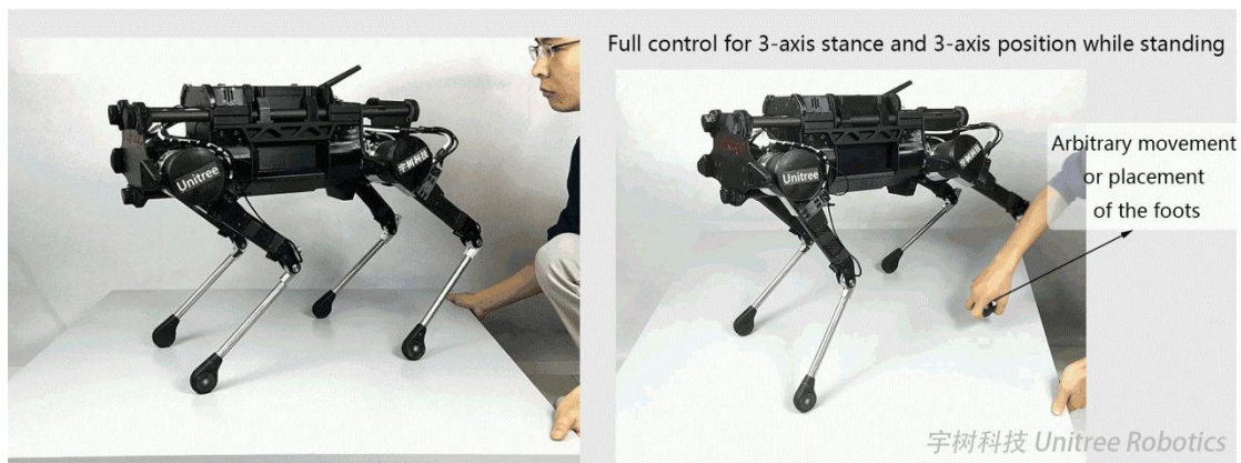
12 个自由度意味着机器人主体可以有全部的 6 个自由度
